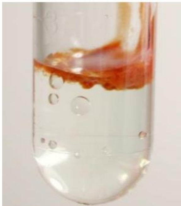
Figura 1 – Precipitado acastanhado formado após interação do NaOCL com CHX.
