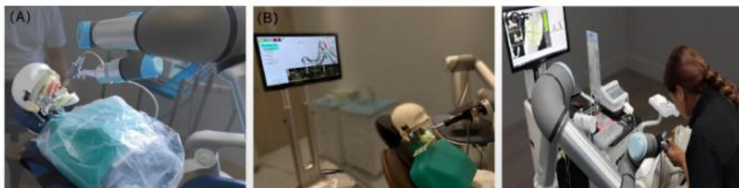
Imagem 3 - Robôs semi-ativo (A), ativo (B) e passivo (C) nas cirurgias de colocação de implantes.
