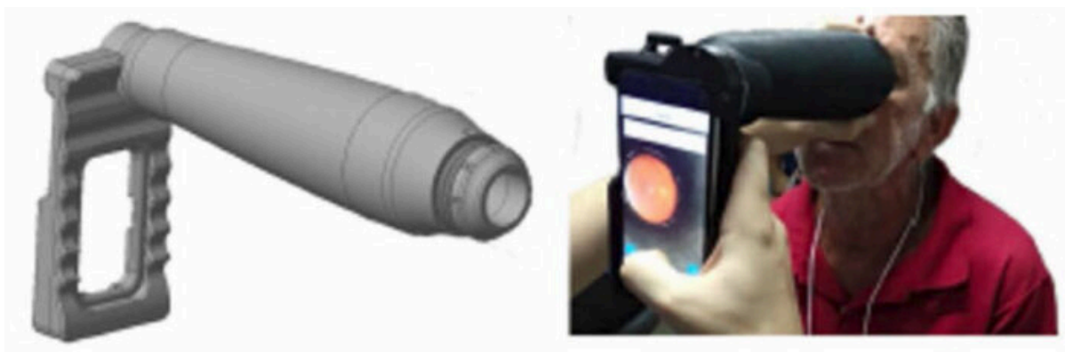
Imagem 10 - Dispositivo Portátil para Imagens da Retina.
