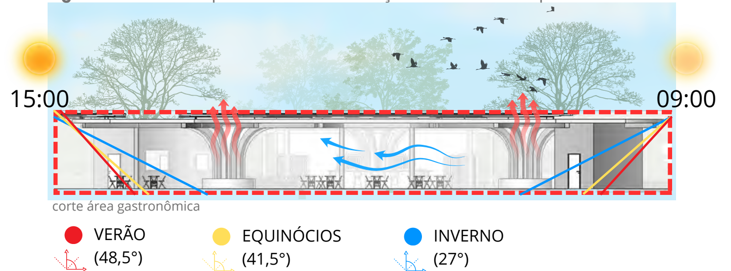
Figura 121 – Corte esquemático com Insolação em diferentes épocas do ano.
