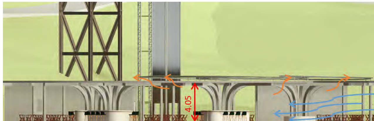
Figura 119 – Corte esquemático com ventilação cruzada e efeito chaminé.
