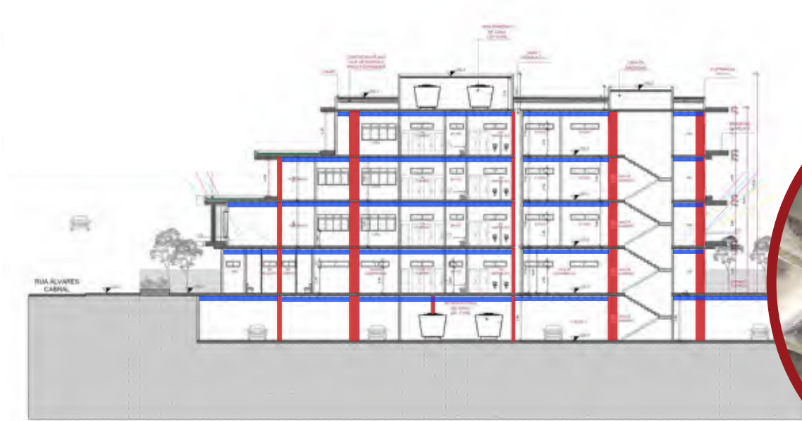
FIGURA 214- SETORIZAÇÃO DE PILAR E VIGA EM CORTE BB
