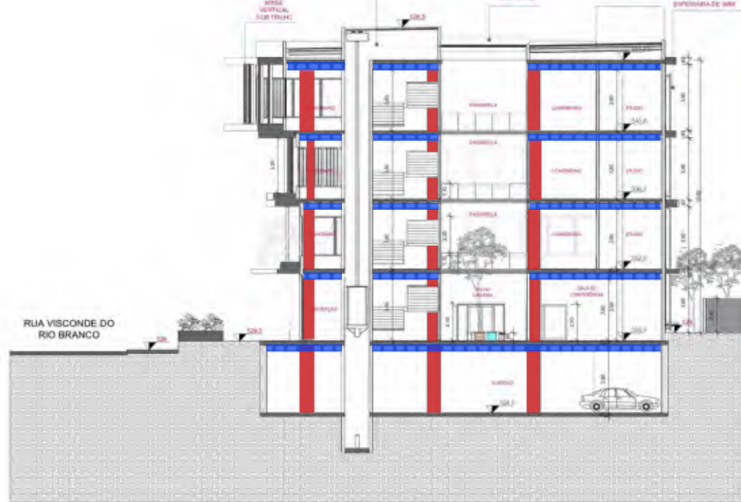
FIGURA 215- SETORIZAÇÃO DE PILAR E VIGA EM CORTE DD
