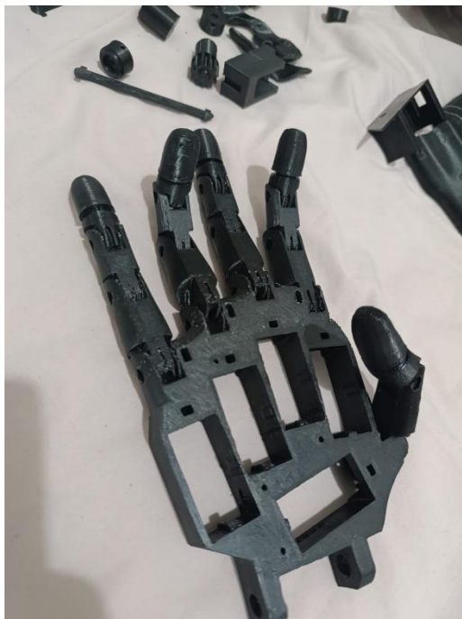
Figura 9 - Início da montagem da mão
