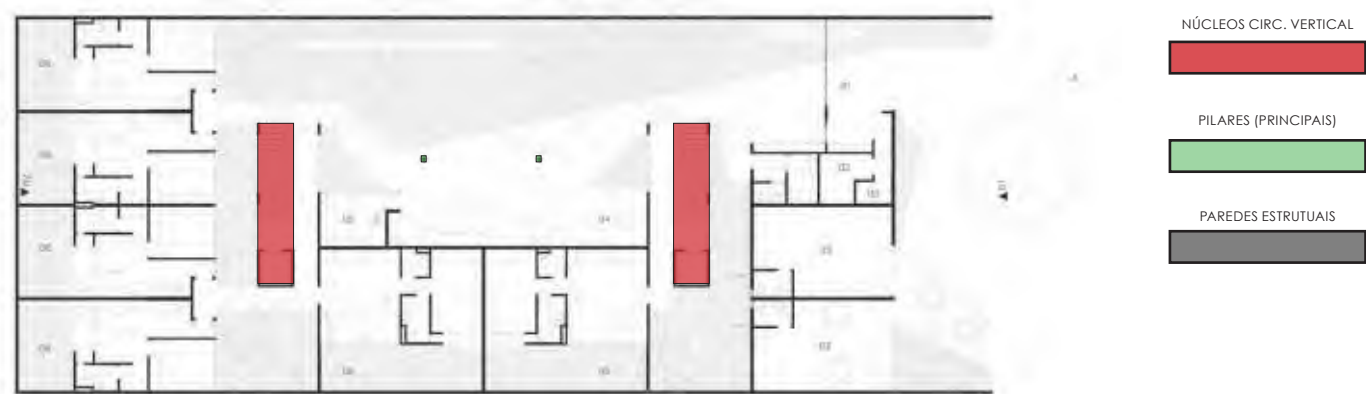
Figura 188 Implantação com lógica estrutural Fonte: https://www.archdaily.com.br/br/1007648/edificio-tico-indiana-terra-e-tuma
