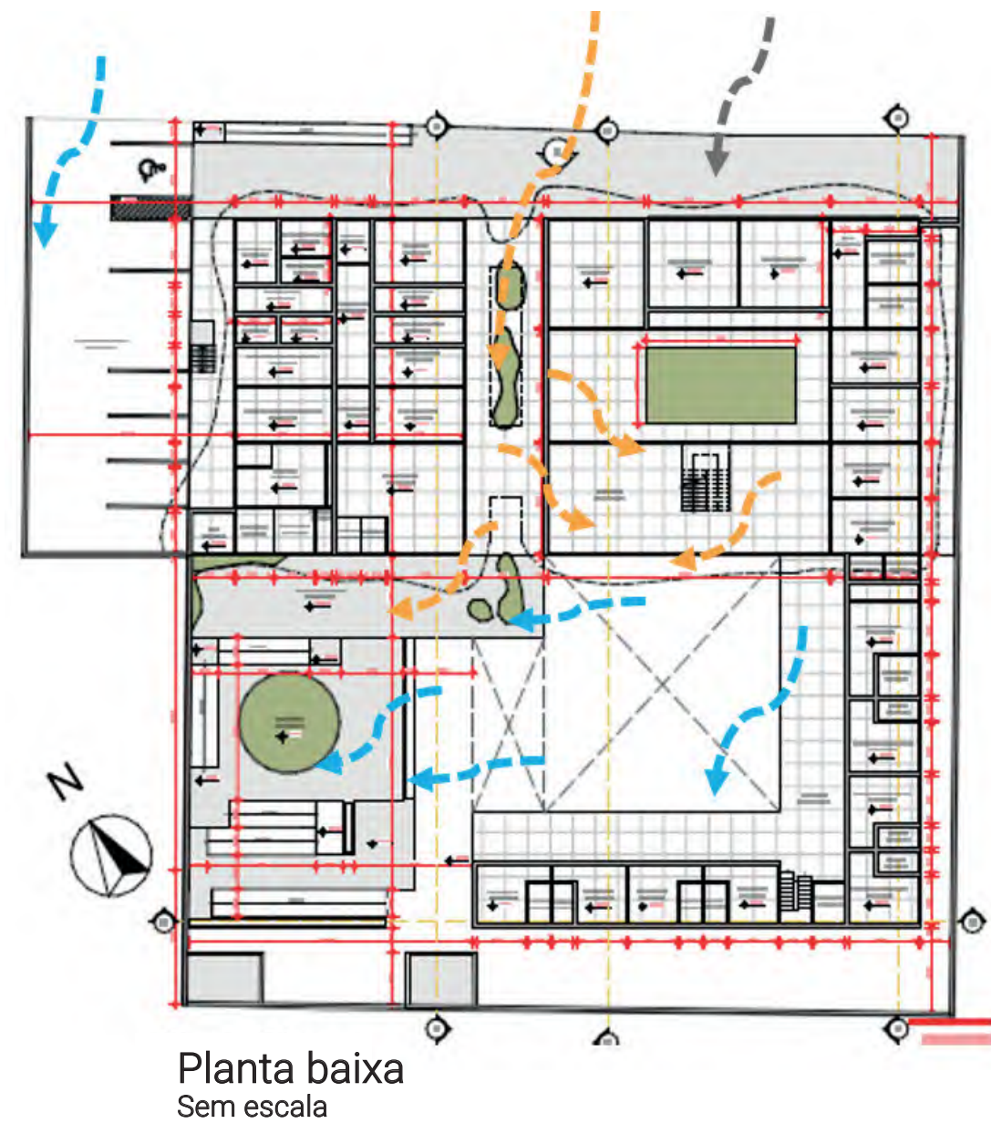
Figura 84 - Planta baixa - estudo de ventilação
