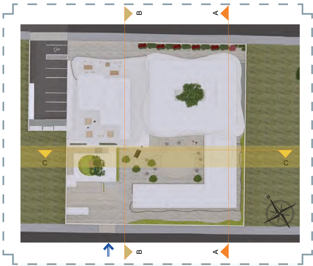
Figura 129 - Implantação - demarcação dos cortes
