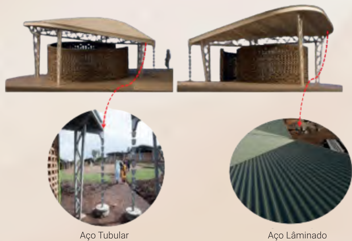
Figura 27 - Estudo sistema construtivo cobertura
