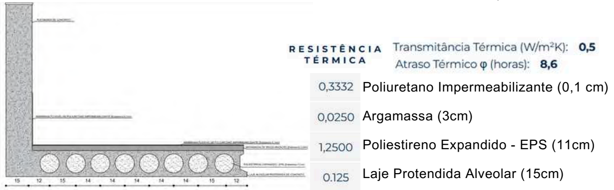
Figura 176: Detalhamento da Cobertura da Biblioteca Pública de Barrinha - SP. Fonte: Elaborado pela Autora, 2024.
