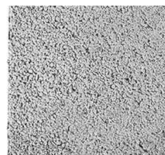
PLACA DE CONCRETO SUSTENTÁVEL DRENANTE
