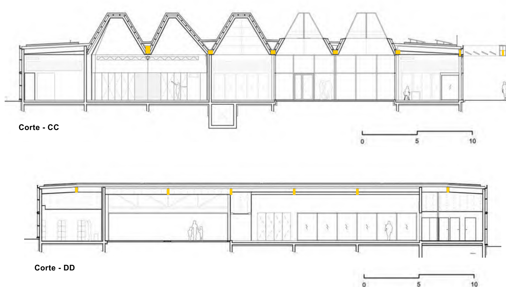
Figura 82: Cortes da Biblioteca Pierre Veilletet - Sistema Estrutural.
