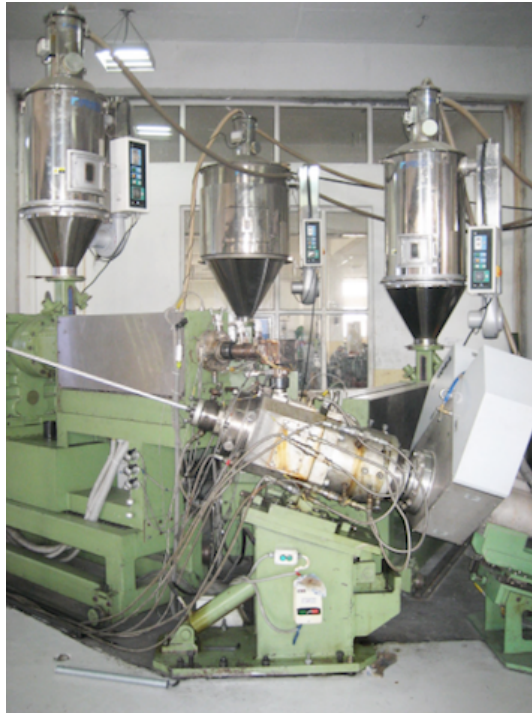
Figura 4 – Equipamento XRAY8000 fixado logo após as extrusoras e pronto para medir as 3 camadas de isolamento do cabo de alta tensão
