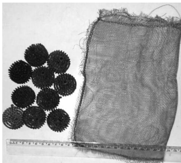
Figura 2. Substrato artificial composto por 10 bioballs e rede de nylon com malha de 1 mm e área de 10 x 10 cm
