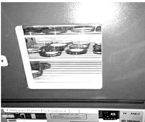
Figura 5. Estufa para crescimento de colôniabacteriana. Foto de: Renata Bazante (2018)
