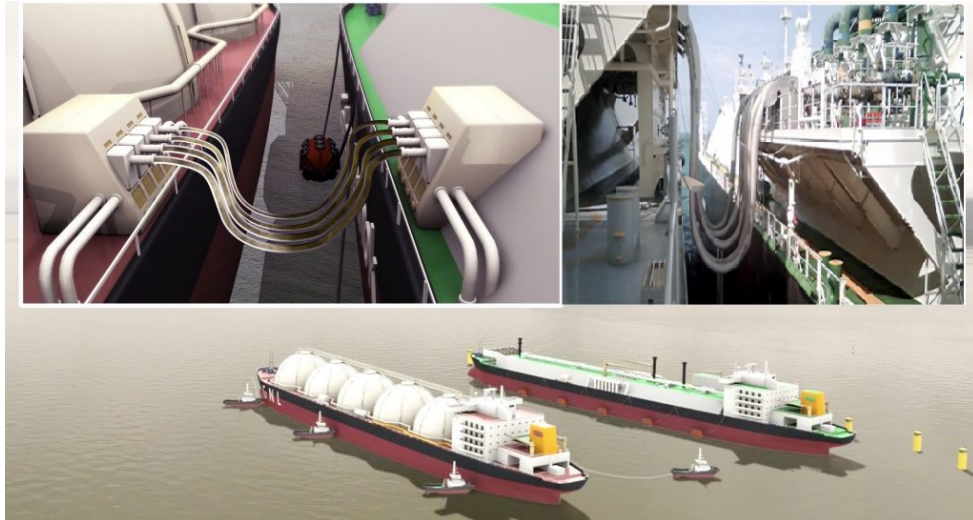
Figura 30 – Offloading de GNL entre unidades paralelas
