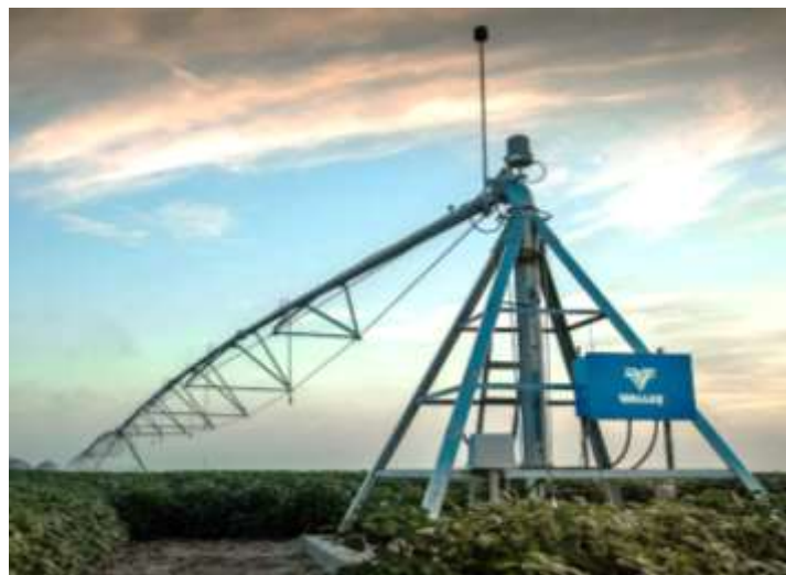
Figura 10 - Sistemas de Irrigação por Aspersão Pivô Central
