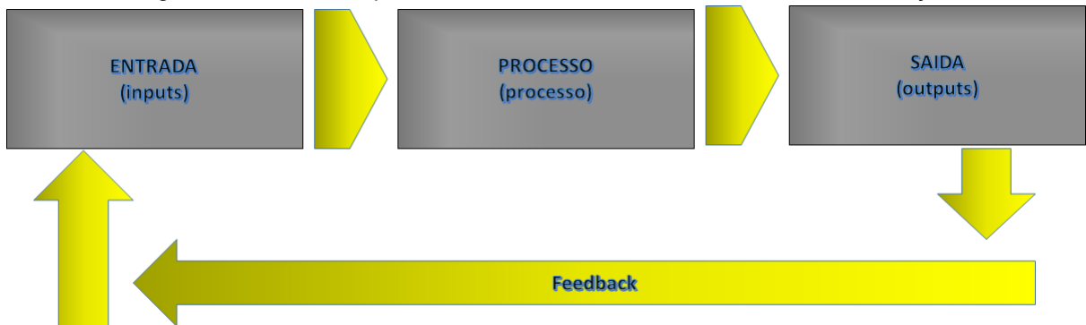
Figura 4 – Modelo simplificado de um sistema cibernético com realimentação
