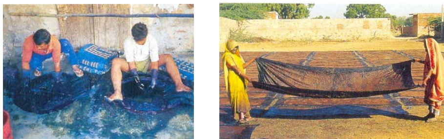
Figura 69 – Trabalhadores dissolvendo o índigo e secagem de tecido ao sol. Fonte: Bhandari (2005)
