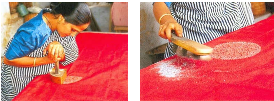
Figura 78 – Aplicação da estampa no tecido. Fonte: Bhandari (2005)
