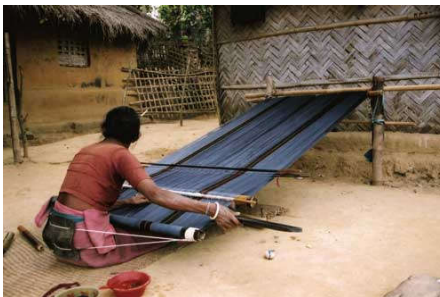
Figura 45 – Tear manual para produção de khadi. Fonte: Flickr (2010)
