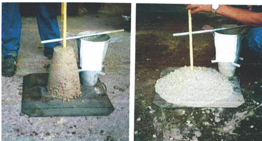
Figura 11: Influência do Aditivo Plastificante
