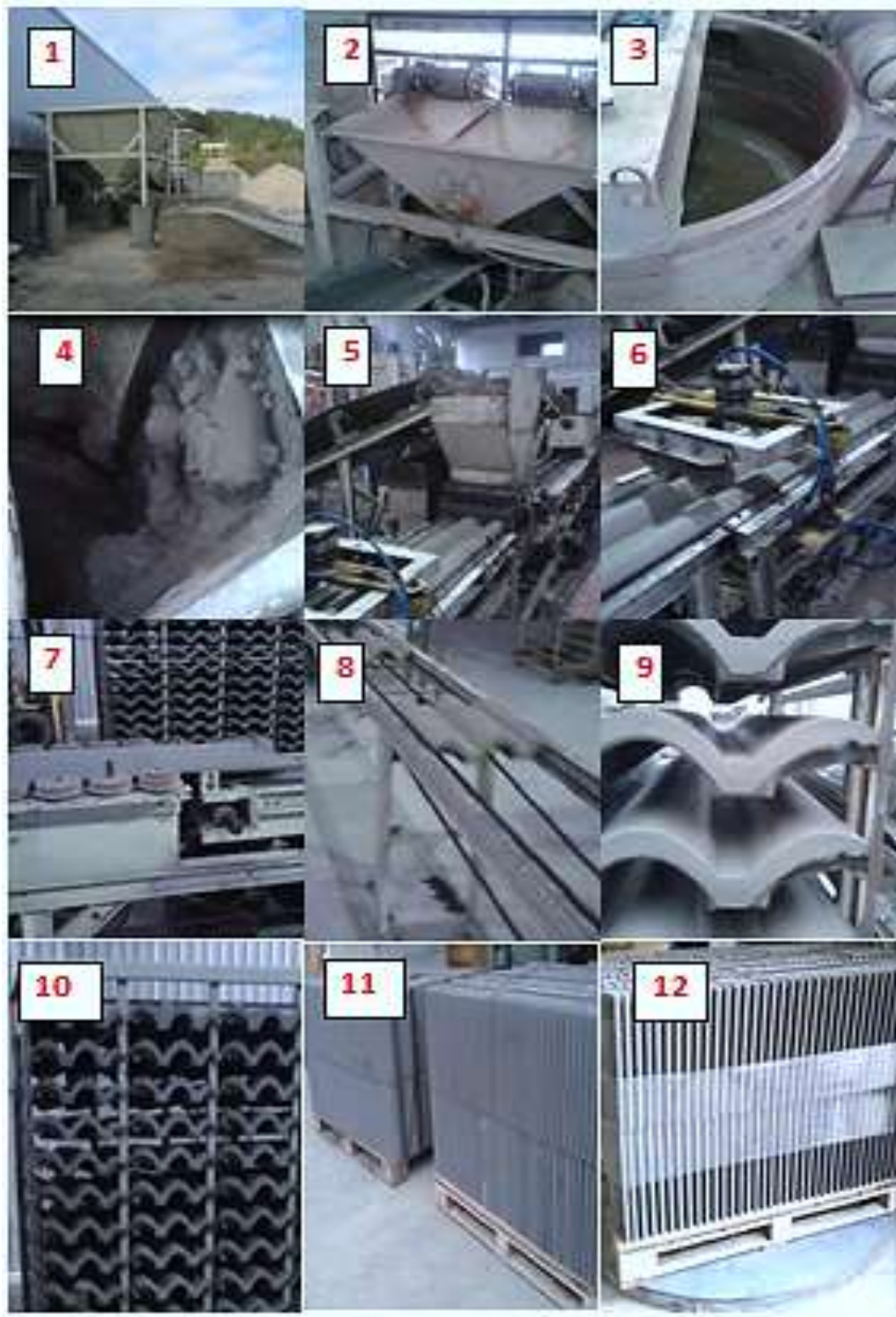
Figura 11 – Fluxo sequenciado do processo de produção de telhas de concreto
