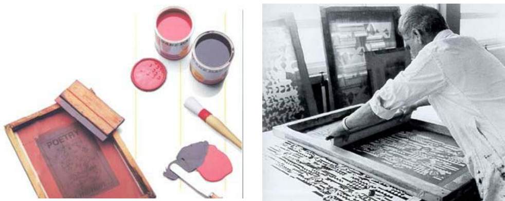
Figura 16 – Quadro de silk screen e aplicação sobre tecido (Fonte: Textile Dyeing)
