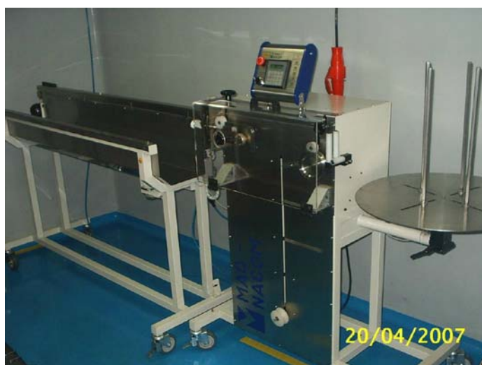
Figura 6.9 – Máquina de cortar tubos de PVC automática – Vida Tecnologia Biomédica (2007)
