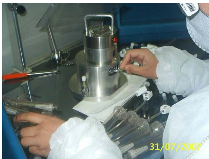
Figura 6.10 – Operação de montagem do gotejador utilizando o dispositivo dosador de solvente – Vida Tecnologia Biomédica (2007)
