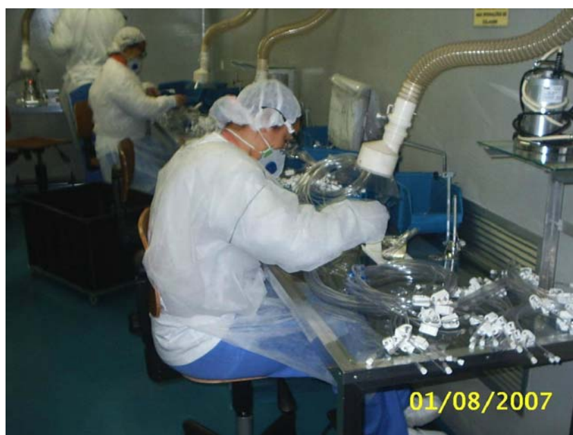
Figura 6.13 – Linha de produção celular do processo de montagem do produto final – Vida Tecnologia Biomédica (2007)
