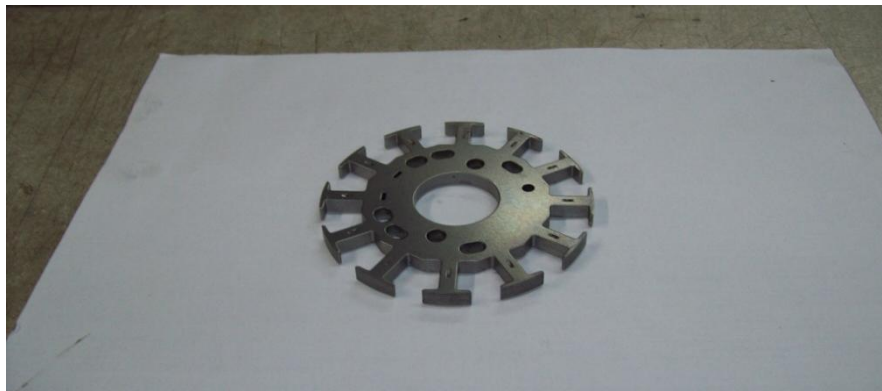
Figura 13 - Foto do autor – Stack feito por lâminas da tira da figura 12
