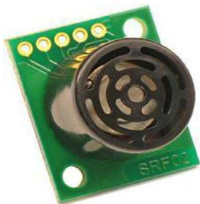
Figura 16 - Sensor de ultrassom: R287-SRF02 (Fonte: Acroname, 2010)
