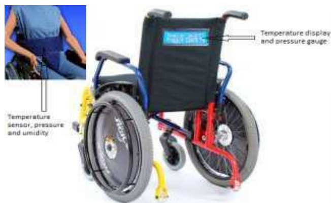
Figura 9: Ilustração de uma Cadeira de Rodas Automatizada com módulo de controle por Rádio Frequência (ControlHelp 1.1), acoplado a ela, com display arduíno de temperatura e pressão.
