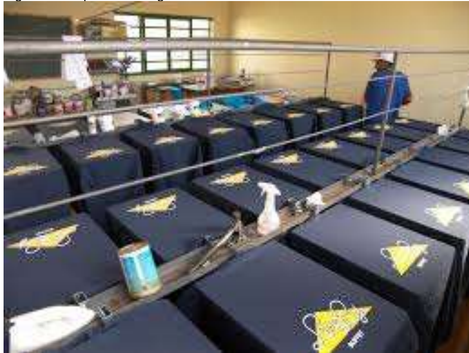
Figura 2 – Impressão serigráfica manual
