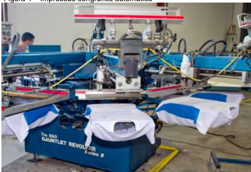
Figura 4 – Impressão serigráfica automática
