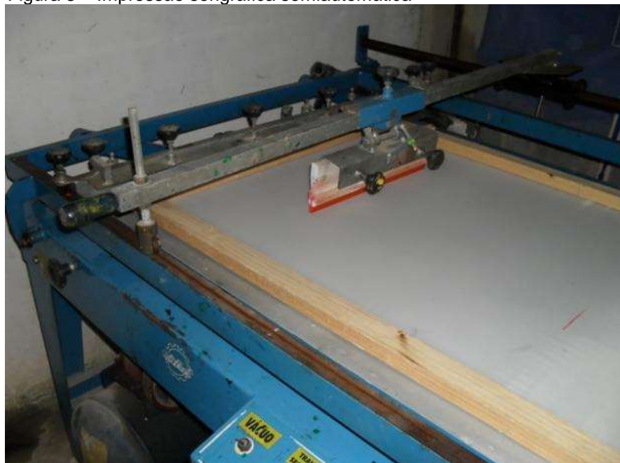
Figura 3 – Impressão serigráfica semiautomática
