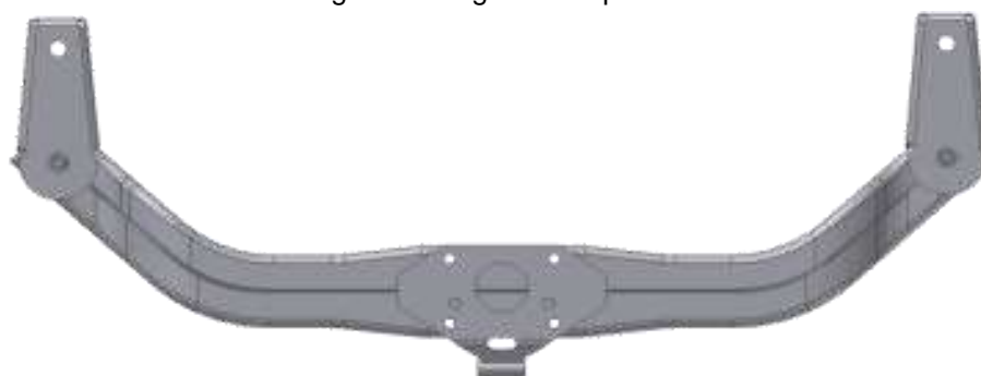
Figura 8 – Viga de Suspensão
