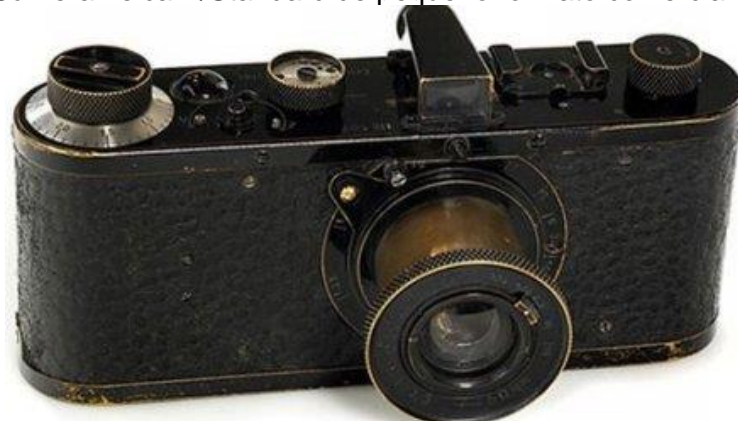
Figura 37 – Câmera Leica A/Standard de pequeno formato comercializada em 1920
