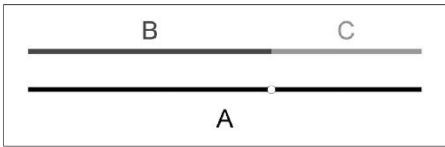
Figura 1. Segmento de reta dividido em média e extrema razão, onde A = 1,618 ; B = 1 ; e C = 0,618 . B/C = A/B = 1,618
