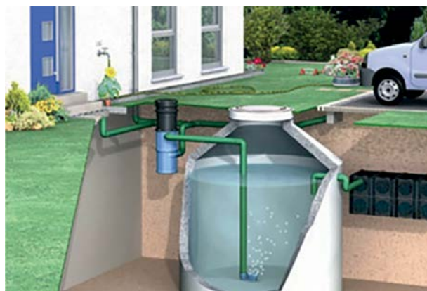
Figura 1 – Esquema de uma cisterna residencial enterrada
