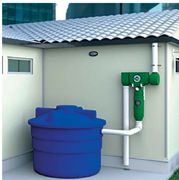
Figura 2 – Filtro acoplado na calha de captação pluvial e cisterna residencial enterrada
