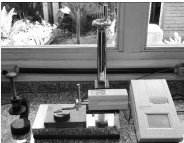
Figura 2. Avaliação da rugosidade superficial por meio de rugosímetro Surf-Corder SE 1700 (Kosakalab)
