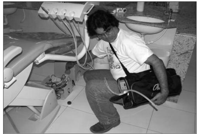
Figura 4. Profissional do CETEM realizando a inspeção do ar do fim da tubulação de dejetos da cuspeira do equipo H
