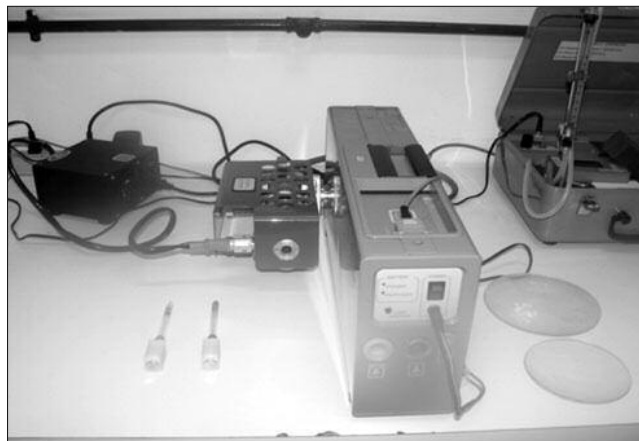
Figura 1. Apresentação física do analisador Zeeman quantitativo que converte em dados a presença de mercúrio em amostras de diversas formas físicas, líquidas, sólidas ou gasosas
