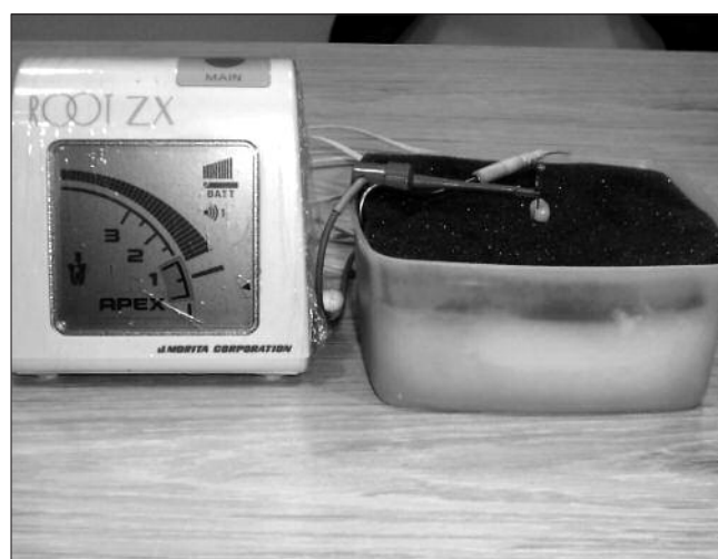
Figura 3. Root ZX em posição 1,0 mm aquém forame
