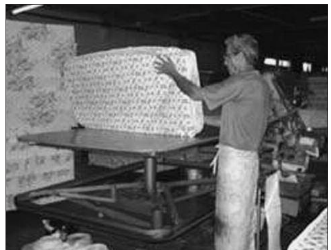
Figura 5. Movimento de manipular o colchão: mesa com plataforma
