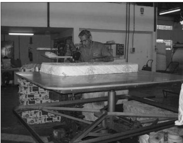
Figura 4. Posicionamento de costura: mesa com plataforma
