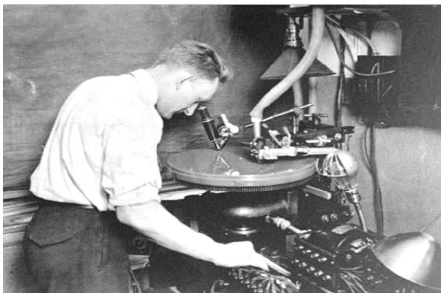
Figura 8 - Gravador de som do sistema Vitaphone (recordinglathe)
