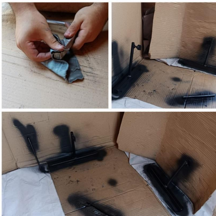
Figura 32- Processo de acabamento das pernas da mesa
