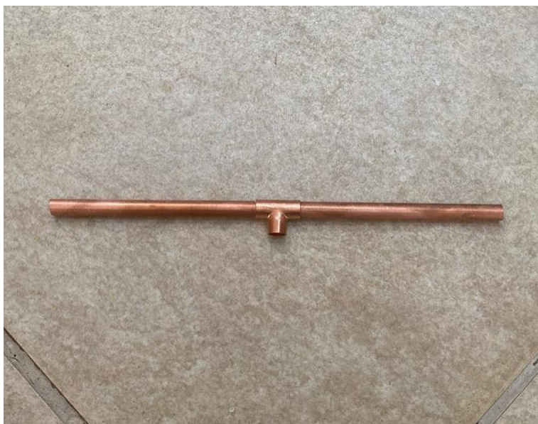
Figura 25 - Conectando tubos no T
