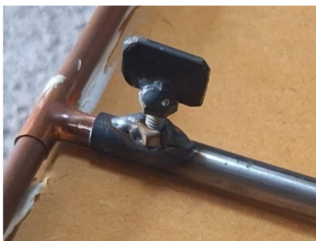
Figura 30 - Sistema de trava regulagem das pernas
