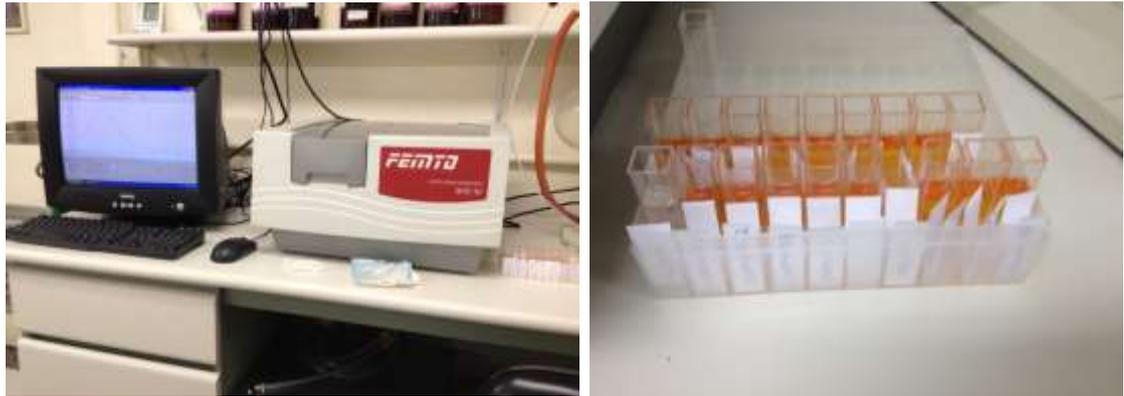
**Figura 3.** Espectrofotômetro. Utilizado na análise de polaridade por corantes solvatocrômicos. As amostras representadas estão imersas no corante ET33.
